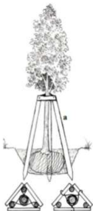
Obr. 5: Kotvení stromu s balem
