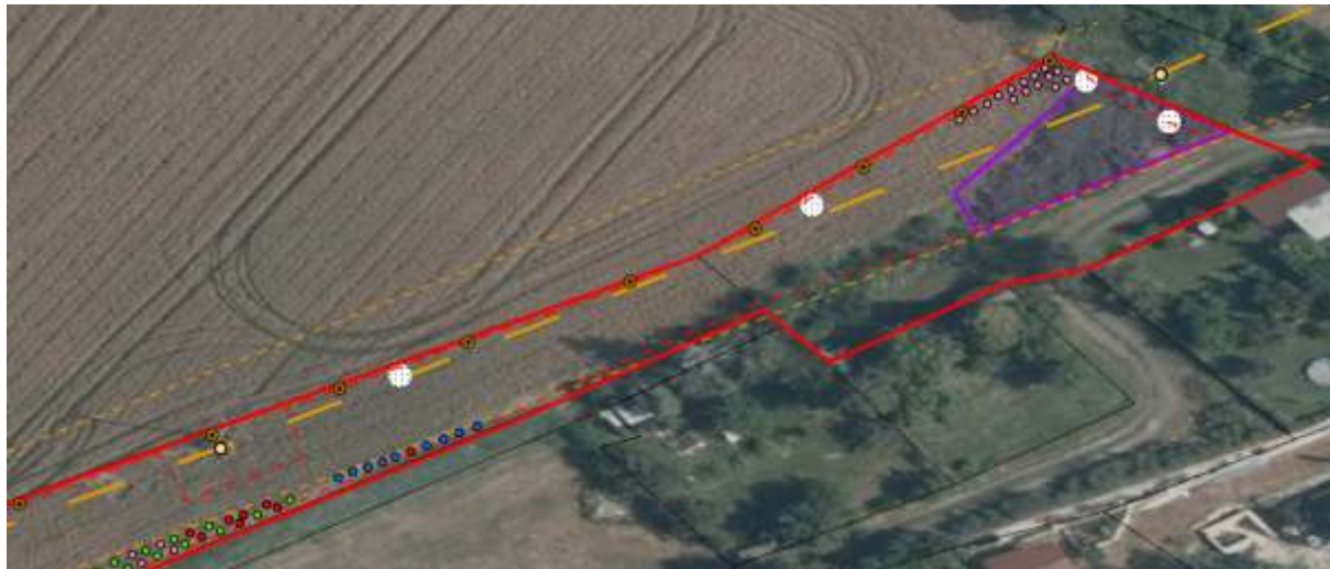
Obr. 11: Schéma výsadby keřů růže šípové v ochranném pásmu a oplocenka ve vzdálenosti větší než 4 m od sloupů VVN (viz červená přerušovaná čára)
